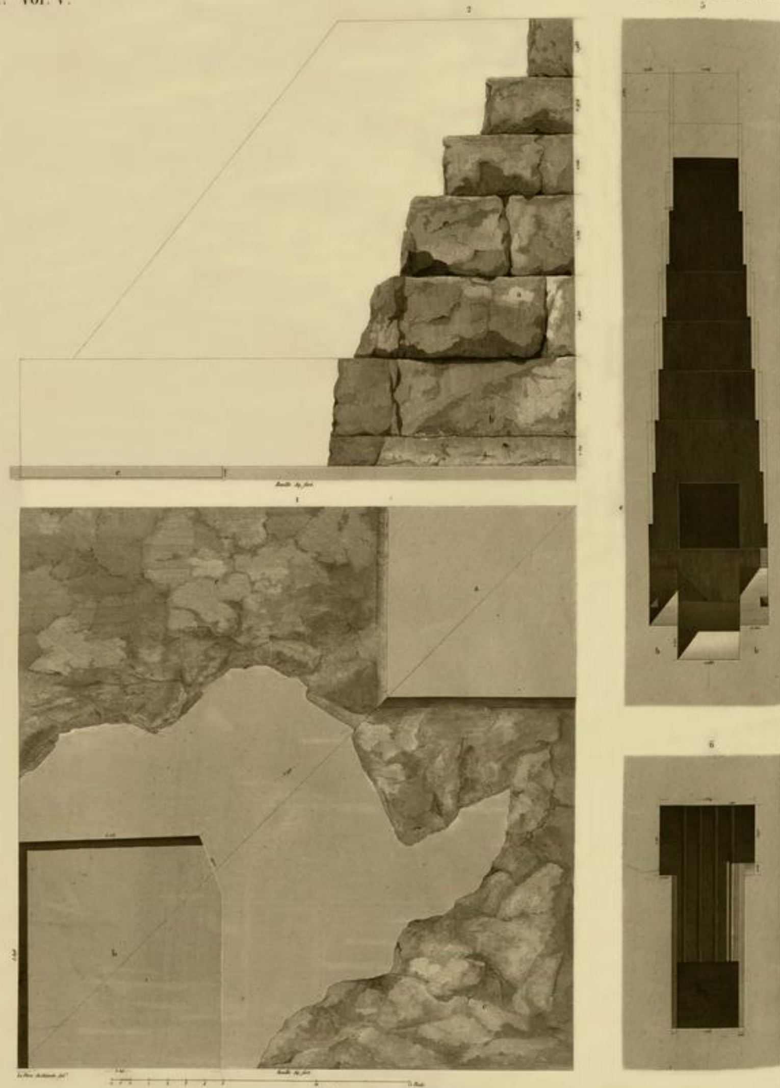
1. 2. PLAN ET ÉLEVATION DE L'ANGLE NORD-EST DE LA GRANDE PYRAMIDE 3. 3. PLAN
