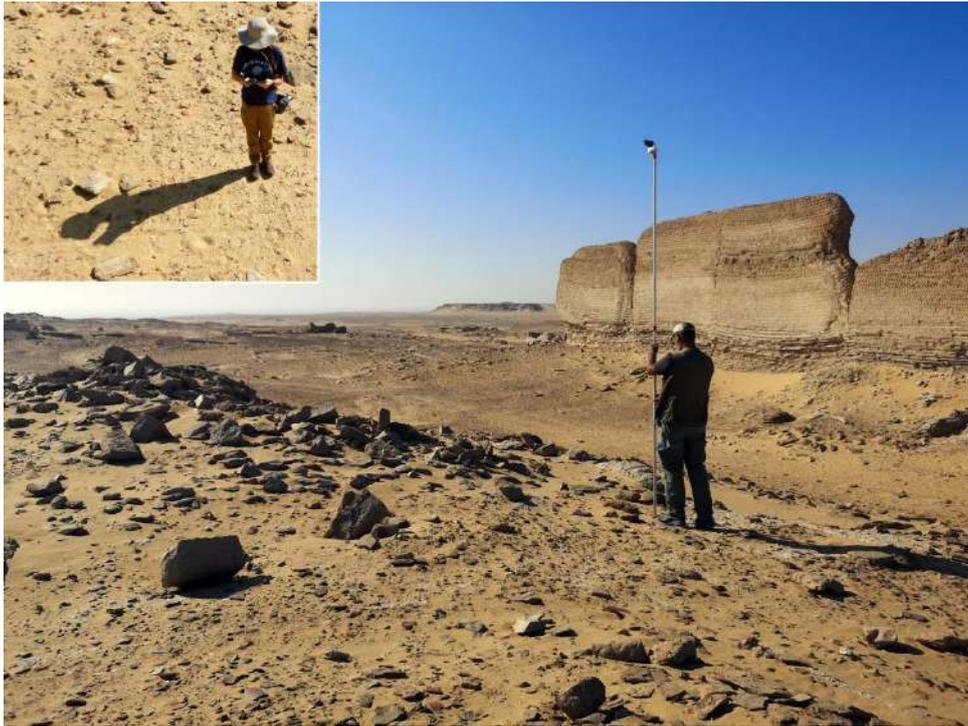
Fig.1 Rilievo digitale *in Image Based in Camera Scanner* eseguito con asta telescopica di m 4
